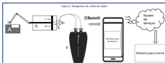
Figura 2: A = motor; B=seringa 3L; C= pneumotacógrafo; D = unidade FITCHECK® conversor Analógico/Digital
