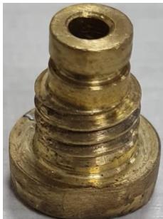
Figura 15. Peça guia de punção fabricada em latão
